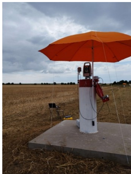
Označenie pilierov a vonkajšia zostava na kalibračnej základnici Viničné
