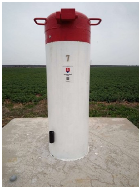
Označenie pilierov a vonkajšia zostava na kalibračnej základnici Viničné
