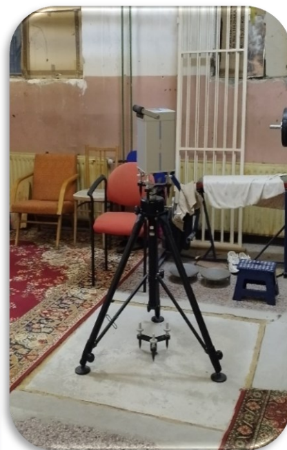
Meranie gradientu tiažového zrýchlenia
