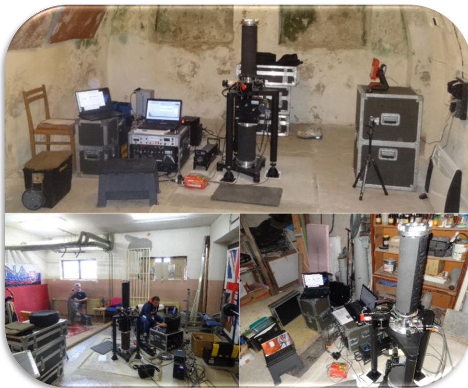
Ukážka merania absolútnym gravimetrom FG5-X na bodoch ŠGS
