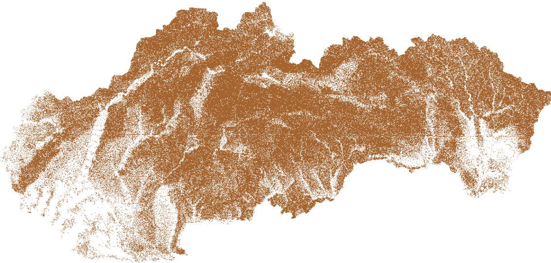
Obr. 2 Vrstevnicová štruktúra DMR50
